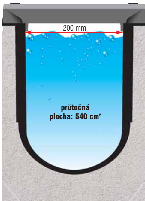
Faserfix Traffic Superblok - průtočná plocha: 540 cm 2
