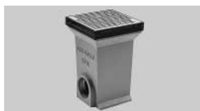
Dvorní vpust z polymerického betonu, litinový rám a rošt z pozinkované oceli - mřížkový, koš (PP), předtvarování s NBR-O-kroužkem pro nátrubek DN 100 a vyjímatelný uzávěr pachů.
